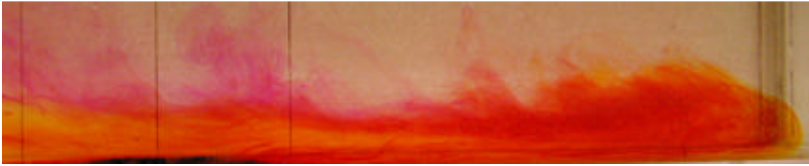
18. ábra: A front és az elhaladása után megmaradt réteg
